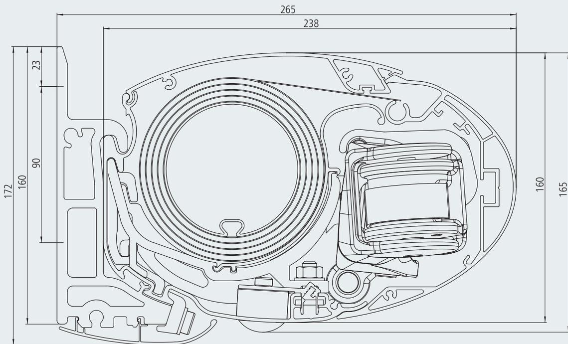
Querschnitt Opal Design II LED Volant Plus mit Motor
