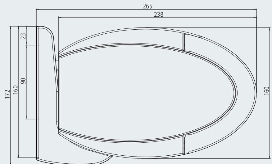
Querschnitt Opal Design II mit Deckenkonsole
