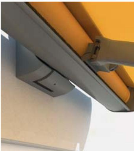
Wandmontage auf Beton C20/25 mit einer Vorsatzverschalung bis zu 200 mm, Windwiderstandsklasse 2 und einer zulässigen zentrischen Zuglast für Bolzenanker von 5,71 kN
