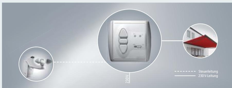
Funktionsprinzip Kabelsystem Uno
