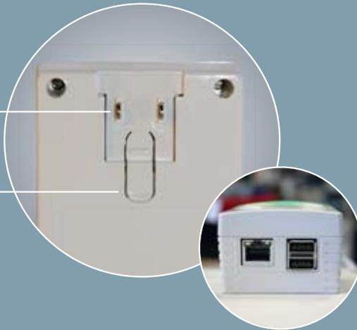
Die Box verfügt über zwei USB-Buchsen für jeweils einen BiEasy Stick. Jeder Stick hat 15 Kanäle sowie Funktionstasten für Kanalwechsel, Programmierung und Auf-/Abfahren bzw. Auf-/Abdimmen.
